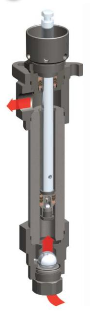
Les pompes à 2 billes figurent parmi les pompes les plus polyvalentes de la gamme ARO. Elles sont adaptées à différents types d'applications, qu'il s'agisse d'un simple transfert ou de l'extrusion de matériaux de faible à moyenne viscosité (jusqu'à 100 000 centipoises [cPs]) avec un débit de produit pouvant atteindre 68,6 L/min.
