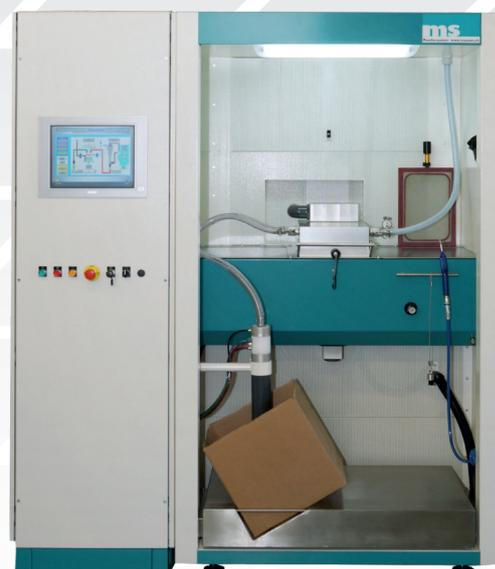
***Tamisage par ultrasons (entre 100 et 200 µm) de la poudre recyclée et de la poudre neuve.***
